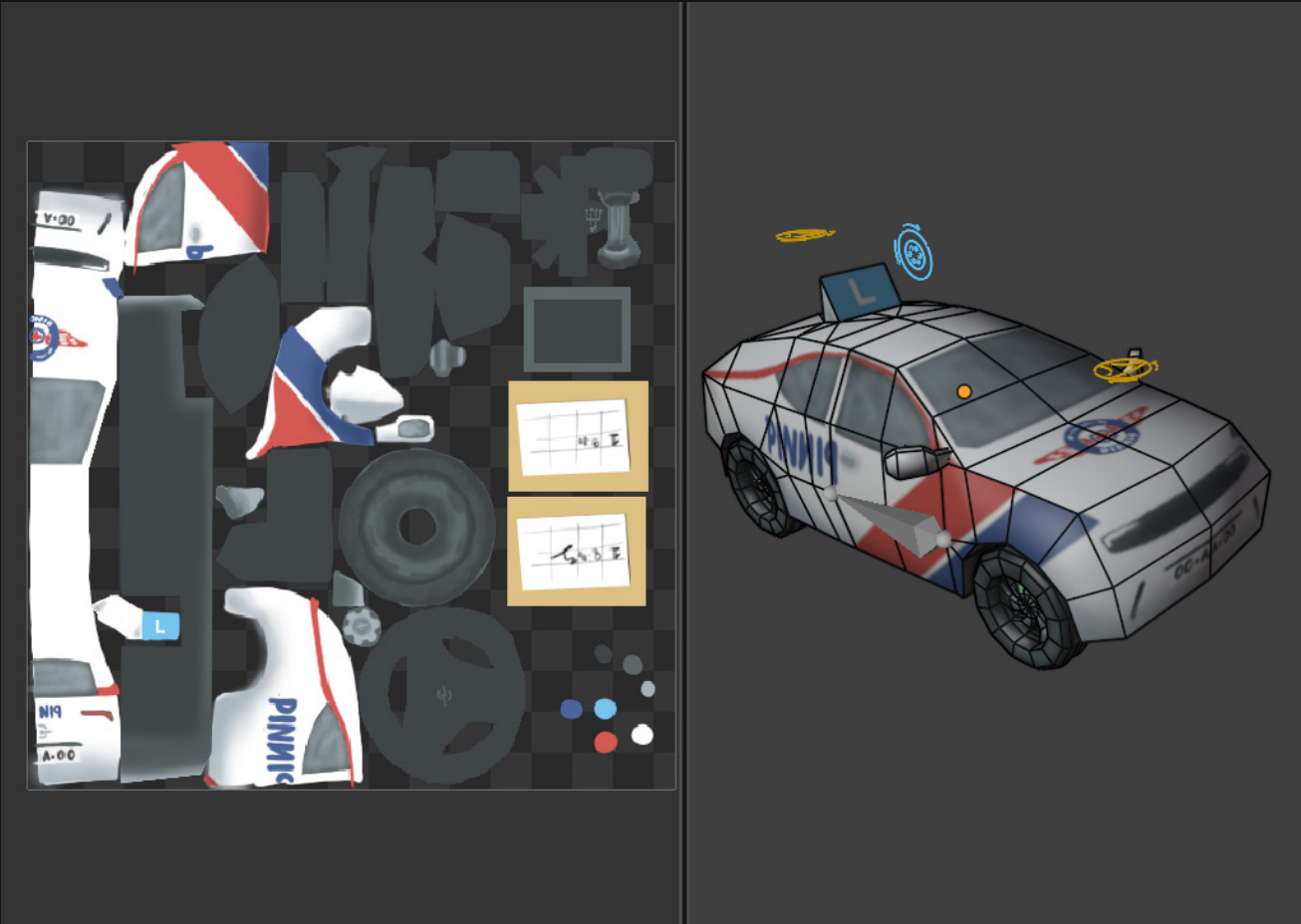
A textura e o modelo tridimensional do carro, respetivamente. É também possível ver os ossos que controlam a abertura das portas e os controladores que se encarregam da rotação das rodas.
